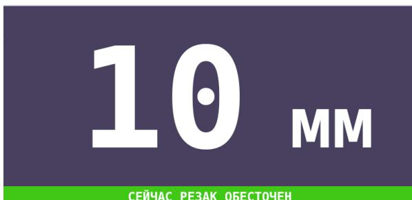
Для работы синергетического алгоритма необходимо установить толщину раскраемого металла.
