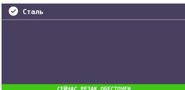
Синергетический алгоритм определяет оптимальные настройки в зависимости от типа металла.
